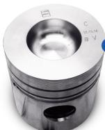
Pístní kroužky (5) jsou označeny logem AGS Premium quality na horní straně kroužku vedle zámku a touto značkou je třeba je montovat směrem nahoru. Zámky pístů je třeba při montáži pootočit proti sobě.
